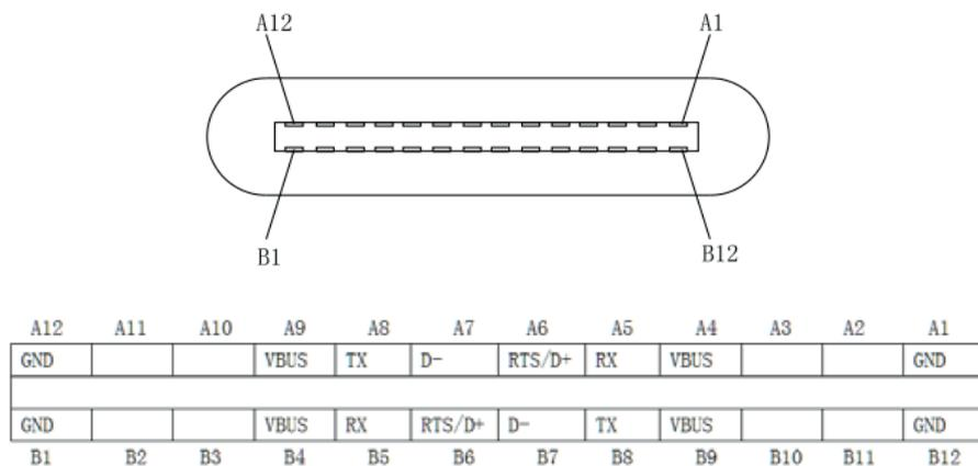
**TXD:** La impresora envía datos a la computadora; cuando se utiliza el protocolo de control de flujo X-ON/X-OFF, la impresora enviará el código de control X-ON/X-OFF a la computadora.
